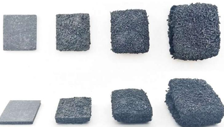
※在不同温度环境下放置5分钟后的热膨胀橡胶板
