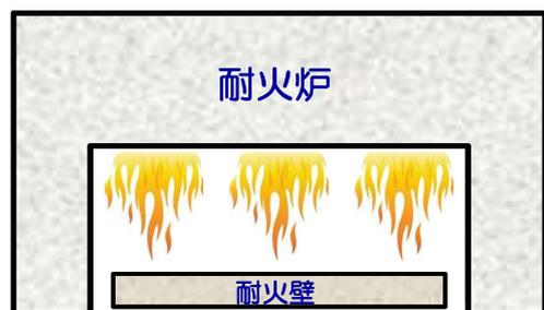
ISO834標準加熱曲線に応じた60分加熱試験を実施
